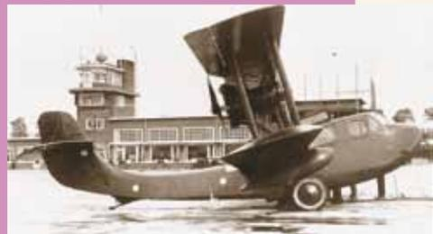
FBA 290 HMT4, hydravion de transport estafette. Directement dérivé du 17, il est un peu plus gros et à cabine fermée, avec un moteur de 300 ch.
