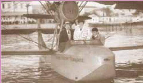
FBA 17 HT4, à moteur de 150 ou 180 ch, un des premiers hydravions utilisés pour le transport de passagers.
