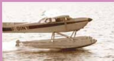
Cessna 172 K en hydroplannage sur ses flotteurs Edo 2440. Le décrochage est proche.
