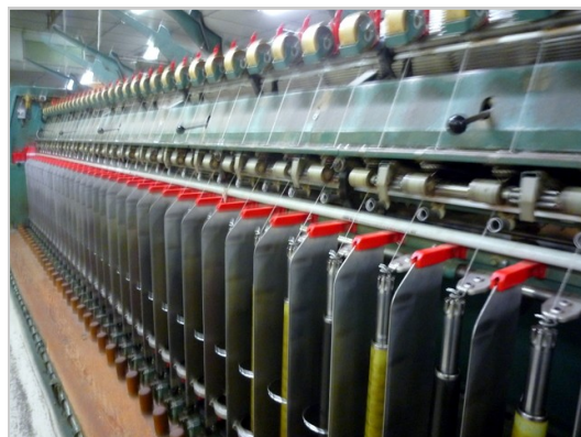
Machine continue à filer
