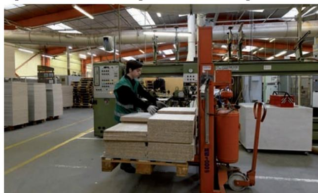
Tout est fait par d'énormes machines-robots, articulées par des bras qui manipulent les planches en tous sens. Elles sont réglées et surveillées par des ouvriers. C'est d'abord le sciage des panneaux de particules qui sont utilisés au maximum des possibilités. Les petites chutes inutilisables sont broyées et servent à chauffer l'usine avec une chaudière biomasse.
