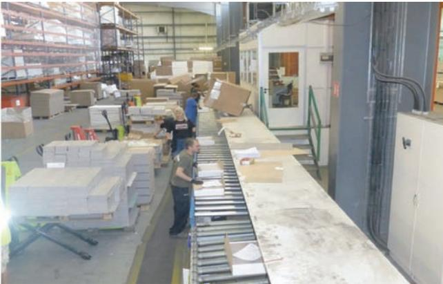
composée de plusieurs personnes : le carton est formé et le polystyrène, découpé sur place, est placé pour caler les pièces qui vont composer le colis (planches, vis, miroirs, charnières, etc. et notice de montage).
