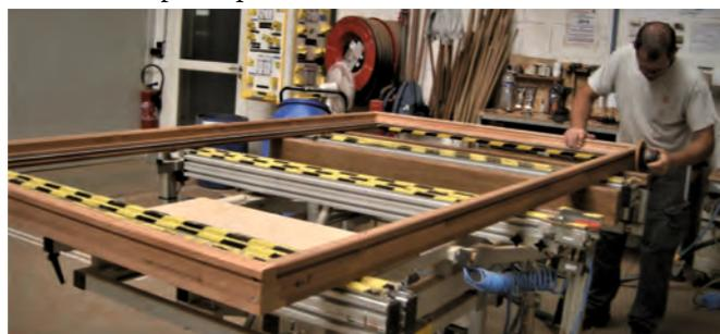
Afin d'assurer la stabilité du matériau et sa résistance mécanique, on utilise la technique du carrelé lamellé-collé 3 plis pour toutes les menuiseries. Les différentes pièces usinées sont ensuite assemblées et traitées (insecticide, fongicide, hydrométrie) avant d'être peintes.
