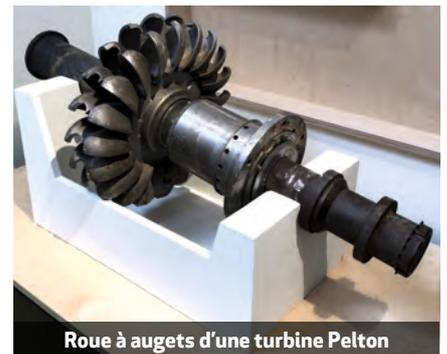
Roue à augets d'une turbine Pelton
